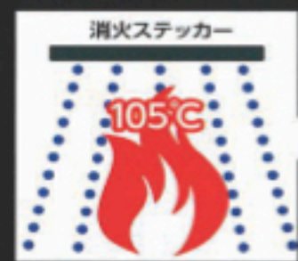
消火剤を自動散布 105℃の熱でマイクロカプセルから消火剤が自動散布
